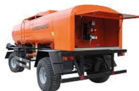
Прицеп-топливозаправщик, V 9,5 м 3
